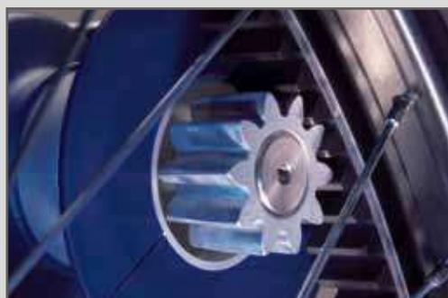
E' facile passare dall'uso manuale a quello elettrico e viceversa della carrozzina per mezzo dell'inserimento ed estrazione dei pignoni che avviene in modo pneumatico.
