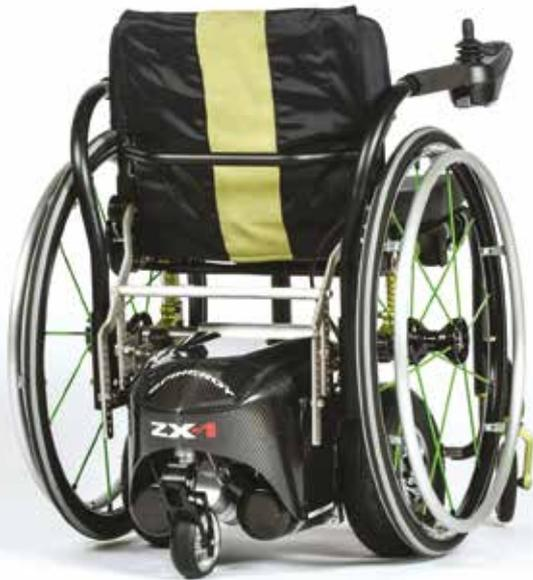
*Il propulsore elettronico ZX1 trasforma in pochi secondi una carrozzina manuale rigida in una carrozzina elettronica con joystick.*
