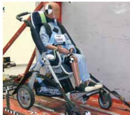
Il prodotto è stato sottoposto a Crash Test ed è risultato conforme ai requisiti della norma EN ISO 7176-19. Significa quindi che questo sistema di seduta è un prodotto ideale per l'utilizzo quotidiano e anche per il trasporto su veicoli a motore idonei e dotati dei punti di ancoraggio e degli elementi di fissaggio idonei.
